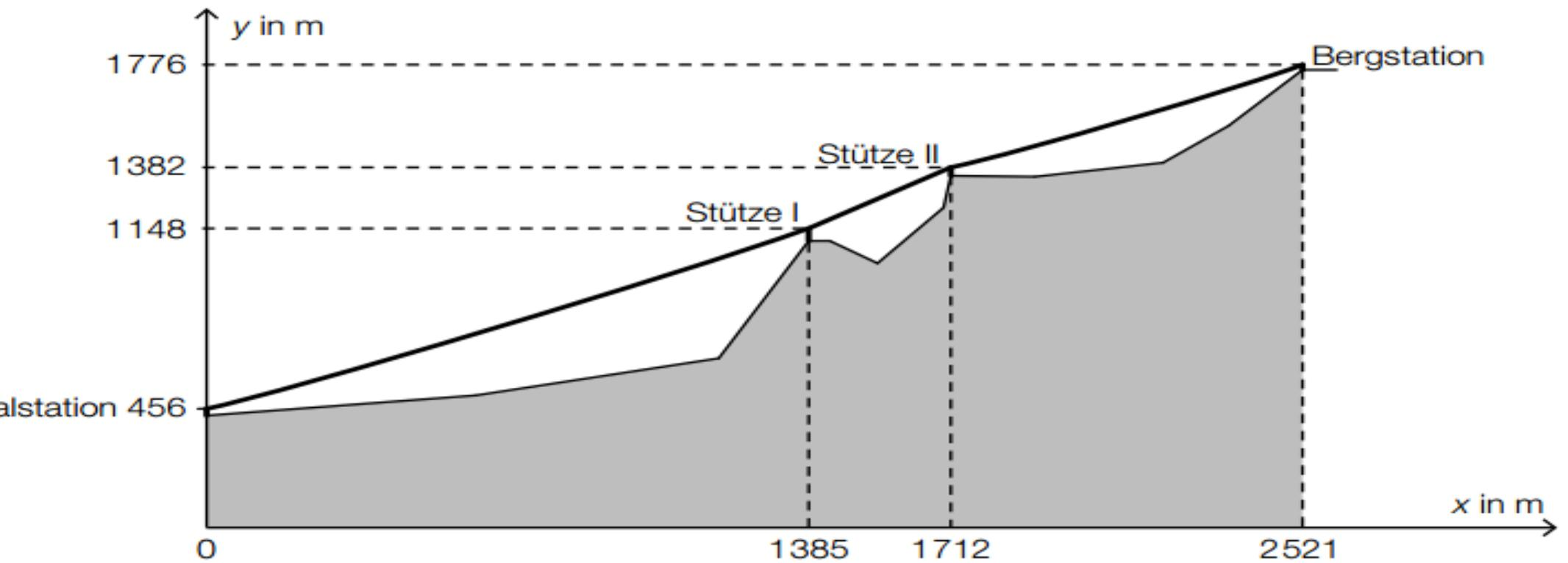
Der Seilverlauf zwischen Stütze I und Stütze II wird vereinfacht als linear angenommen.
